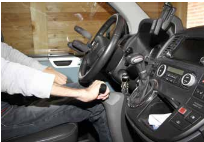
Behindertengerecht ausgestattetes Auto. Jedes Fahrzeug wird individuell an die behinderte Person angepasst.
