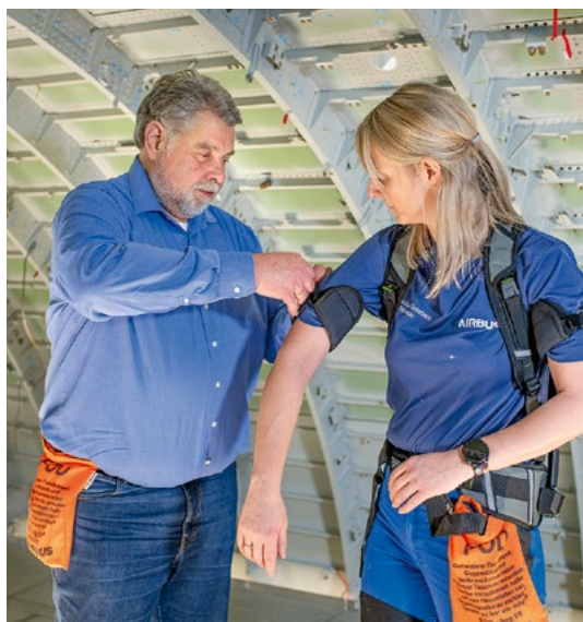
Christian Boehm, Fachkraft für Arbeitssicherheit, prüft, ob das Exoskelett von Franziska Christians gut eingestellt ist.
