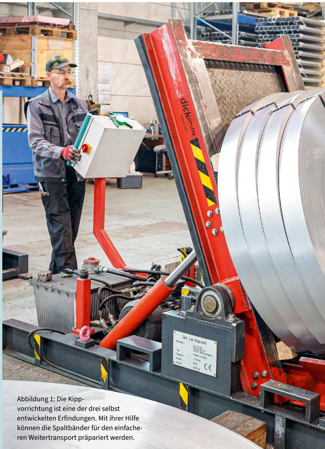
Abbildung 1: Die Kippvorrichtung ist eine der drei selbst entwickelten Erfindungen. Mit ihrer Hilfe können die Spaltbänder für den einfachen Weitertransport präpariert werden.
